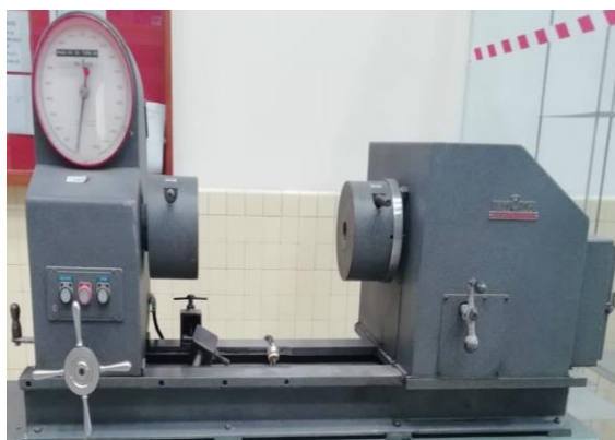
Figura 3.7. Máquina para ensayos de torsión del laboratorio UCE
