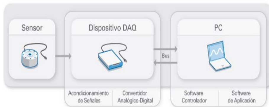
Figura 3.13. Partes de un sistema de adquisición de datos
