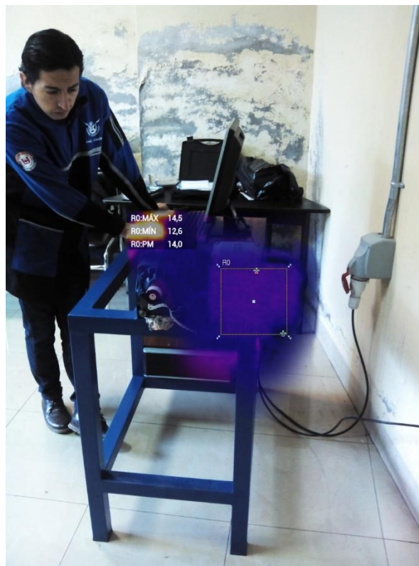
Figura V.2. Análisis termográfico con una temperatura promedio de 14°C
