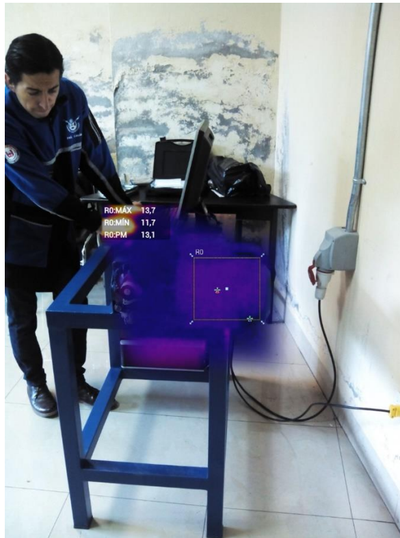
Figura V.1. Análisis termográfico con una temperatura promedio inicial de 13,1°C
