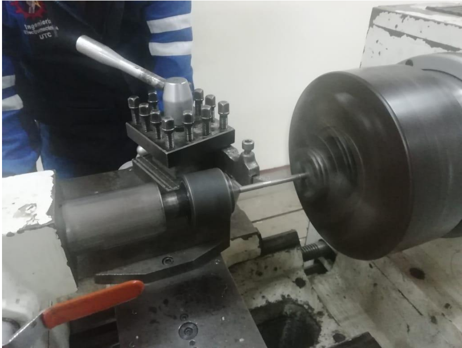
Figura VII.7. Elaboración de probetas para los ensayos de torsión
