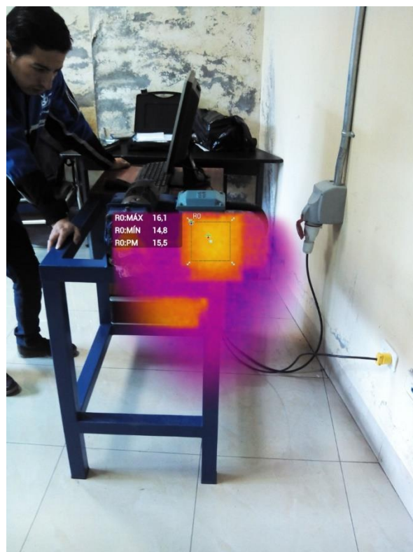
Figura V.4. Análisis termográfico con una temperatura promedio de 15,5°C
