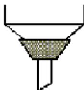
**DESCRIPCIÓN:** Es un embudo con la base agujereada. Se acopla por su extremo inferior mediante un corcho taladrado al matraz kitasato. Encima de los orificios se coloca un papel de filtro. Se utiliza para filtrar sustancias pastosas
