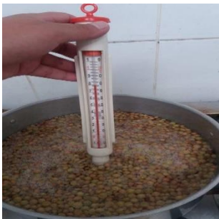
Fotografía 27. Escaldado de la lenteja a 80°C por 15 minutos
