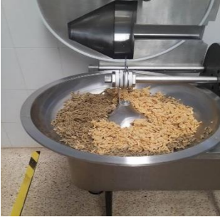
Fotografía 31. Adición de las materias primas en el cúter
