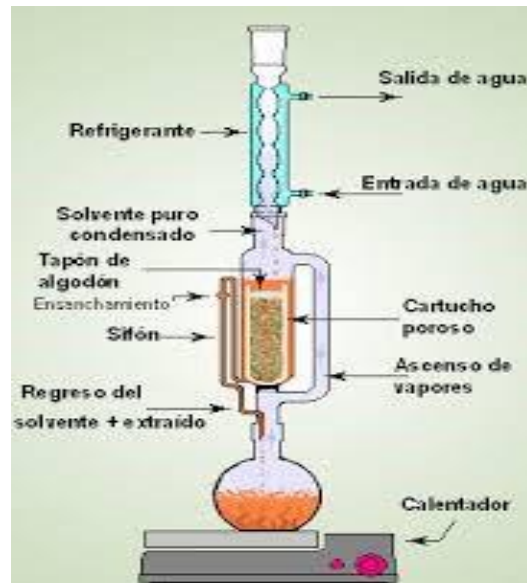
Imagen 3: Equipo Soxhlet utilizados para la extracción de saponinas.
