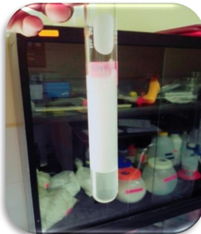
Fotografía 16 Medición de espuma.
