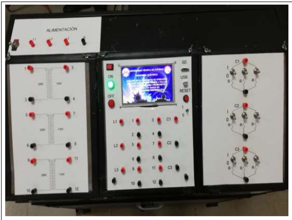
Figura III.5. Módulo relé diferencial MRD-87T.
