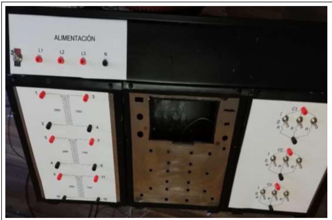
**Figura III.3.** Colocación de borneras en el módulo relé diferencial MRD-87T.
