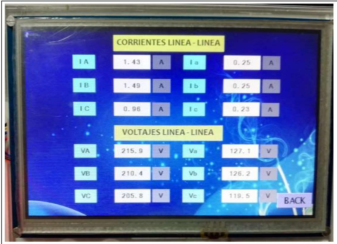
**Figura IV.** Corrientes obtenidas con una carga de  $6.4\Omega$  y con un factor de corrección de 0.2
