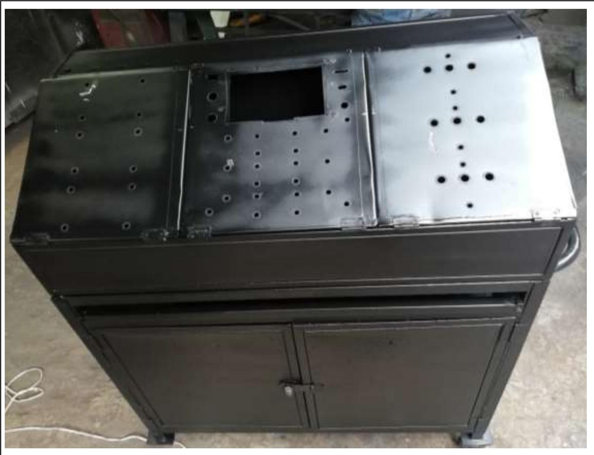
**Figura III.2.** Construcción de la estructura del módulo relé diferencial MRD-87T.
