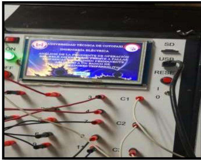
**Figura 1.** Conexión a la entrada USB del módulo.
