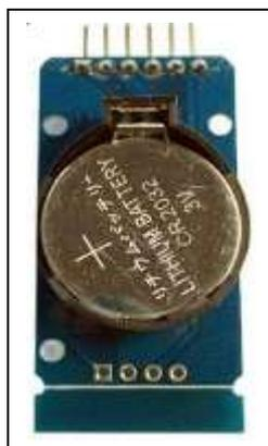
**Figura 3. 16.** Reloj para Arduino RTC
