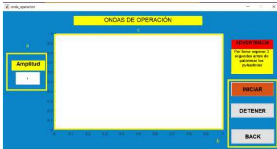
**Figura 7.** Ventana para visualizar las ondas de corriente, Guide-Matlab.
