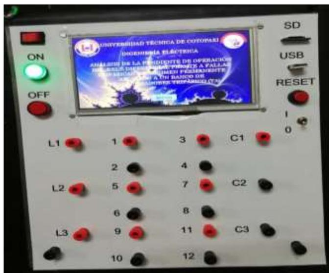
**Figura 5. 7.** Designación de las borneras del relé diferencial.
