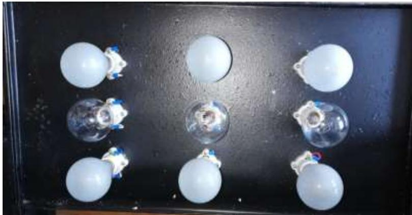
**Figura 5. 8.** Instalación de las cargas resistivas al módulo relé diferencial.
