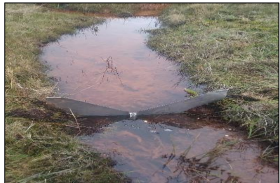
Figura 4. Vertedero de 90° instalado en la sequía número 2
