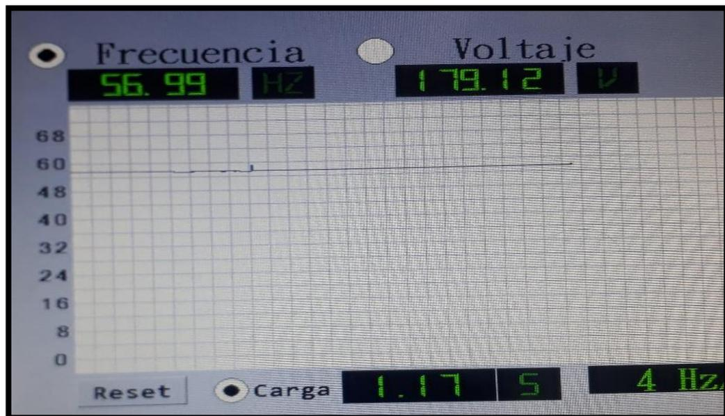
**Figura 5.32.** Respuesta de operación del generador a una carga inductiva por fase de 1146,055Ω.
