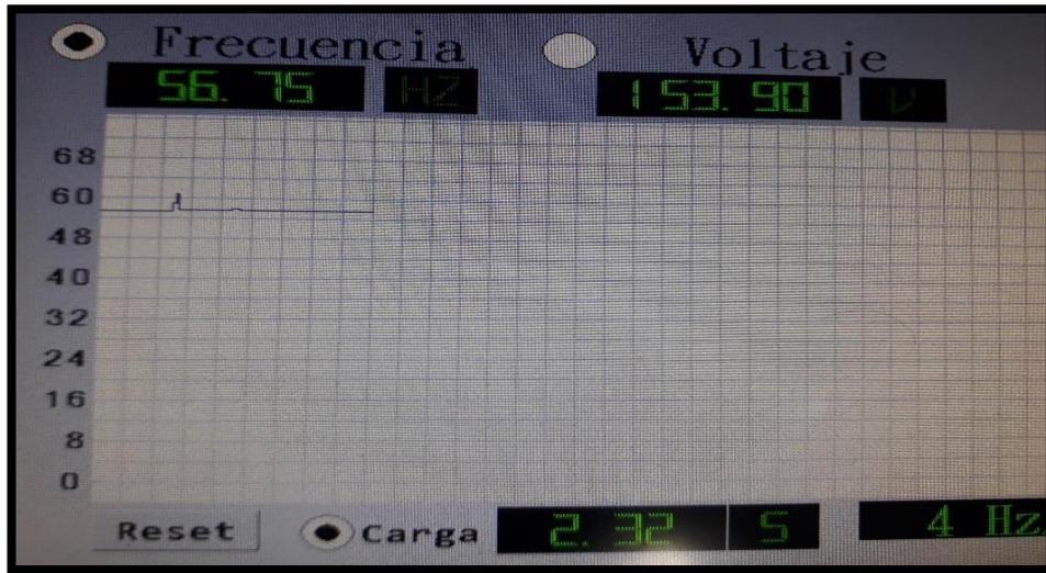
**Figura 5.34.** Respuesta de operación del generador a una carga inductiva por fase de  $286.51\Omega$ .
