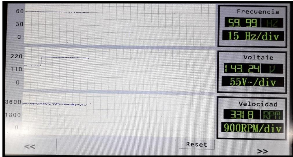
**Figura 5.52.** Respuesta de frecuencia, voltaje y velocidad a una carga resistiva de  $58.76 \Omega$ .
