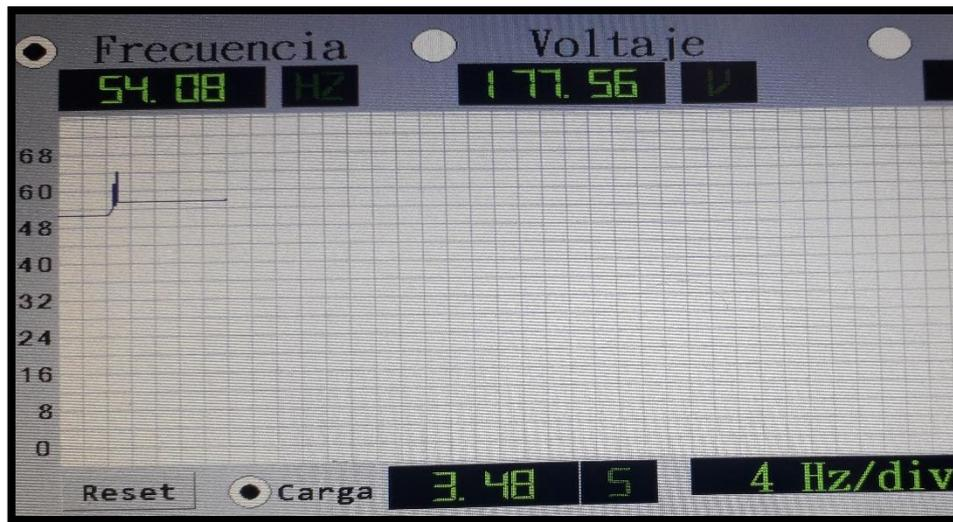
Figura 5.25. Respuesta de operación del generador a una resistencia por fase de  $600\Omega$ .
