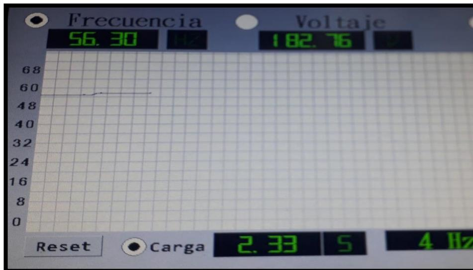
**Figura 5.38.** Respuesta de operación del generador a una carga R, L por fase de  $1200 \Omega + j1146,055 \Omega$ .
