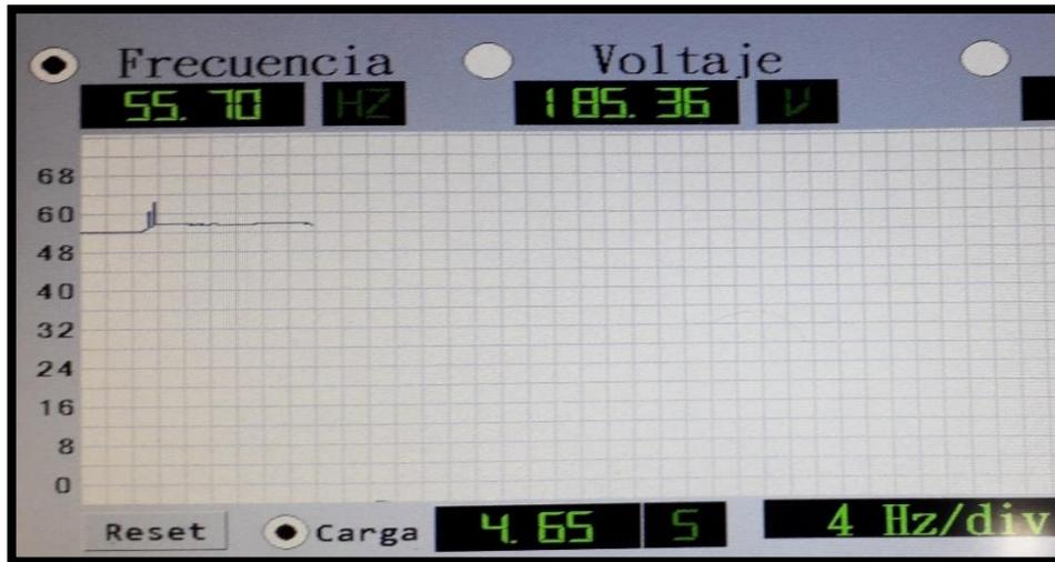
Figura 5.23. Respuesta de operación del generador a una resistencia por fase de  $1200\Omega$
