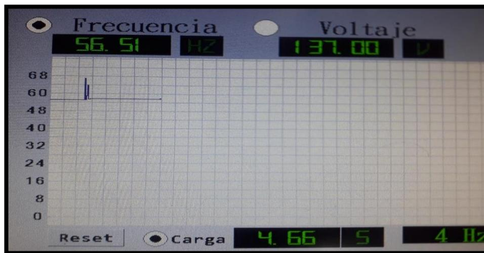
**Figura 5.36.** Respuesta de operación del generador a una carga inductiva por fase de 191 $\Omega$ .
