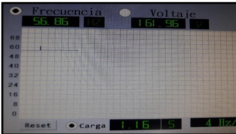
**Figura 5.35.** Respuesta de operación del generador a una carga inductiva por fase de  $382.014\Omega$ .
