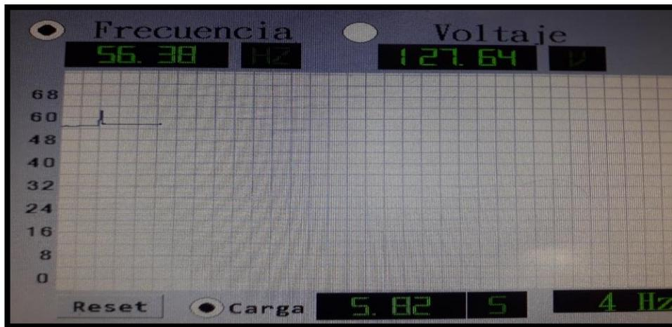
**Figura 5.37.** Respuesta de operación del generador a una carga inductiva por fase de  $163.72\Omega$ .
