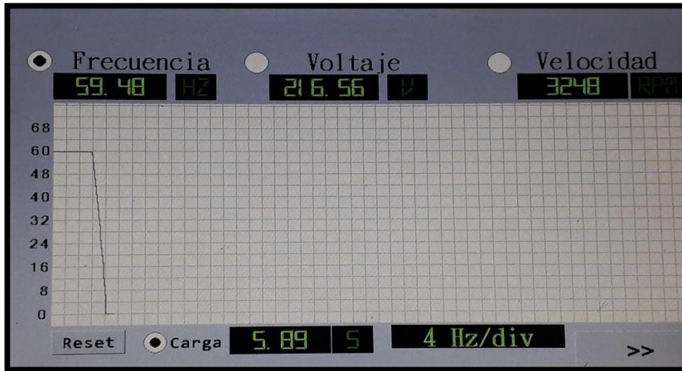
**Figura 5.43.** Respuesta de operación del generador en condiciones normales.
