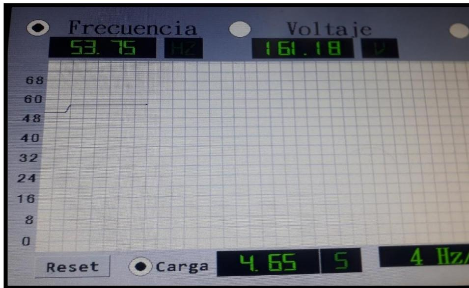
**Figura 5.40.** Respuesta de operación del generador a una carga R, L por fase de  $300\Omega + j286.51 \Omega$ .
