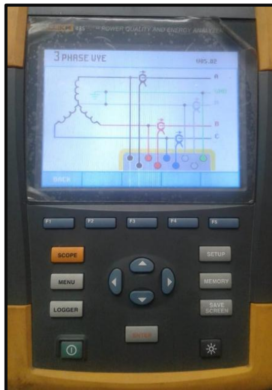
Figura 31: Modo de conexión de las sondas
