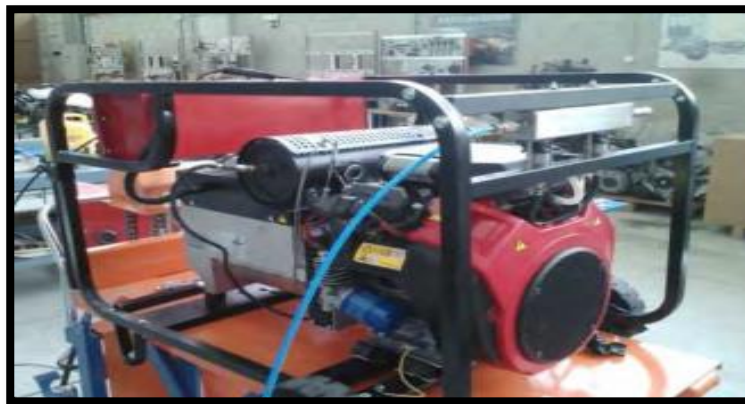
Figura 10: Motor y turbina de hidrógeno (robusto y sin emisiones de co2)
