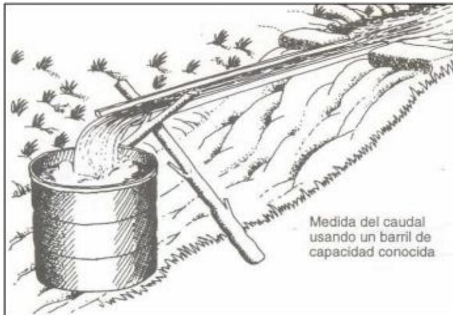
**Figura 6.** Usando el método del recipiente
