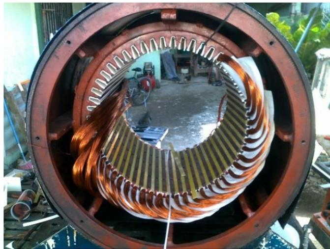
**Figura 8.** Estator o Armadura
