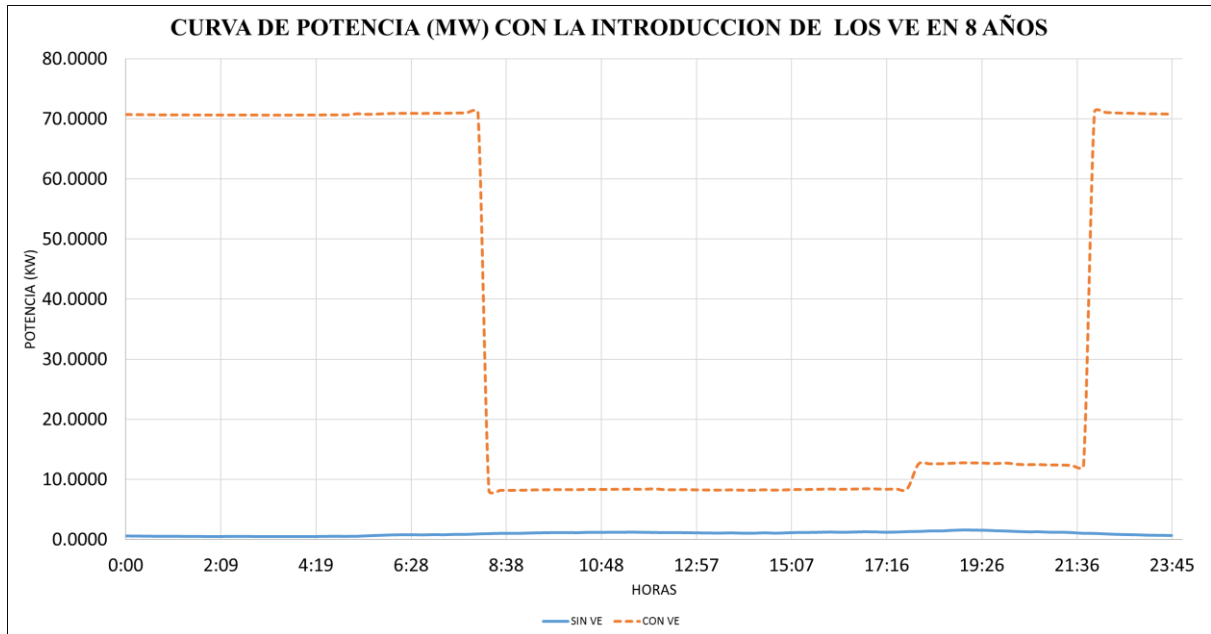
Figura 16.7: Curva de Potencia (MW) con la Introducción de los Vehículos Eléctricos en un Periodo de 8 Años Elaborado Por: Investigadores
