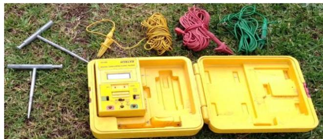
**Ilustración 11.20.** Telurómetro marca EXTECH 382158.
