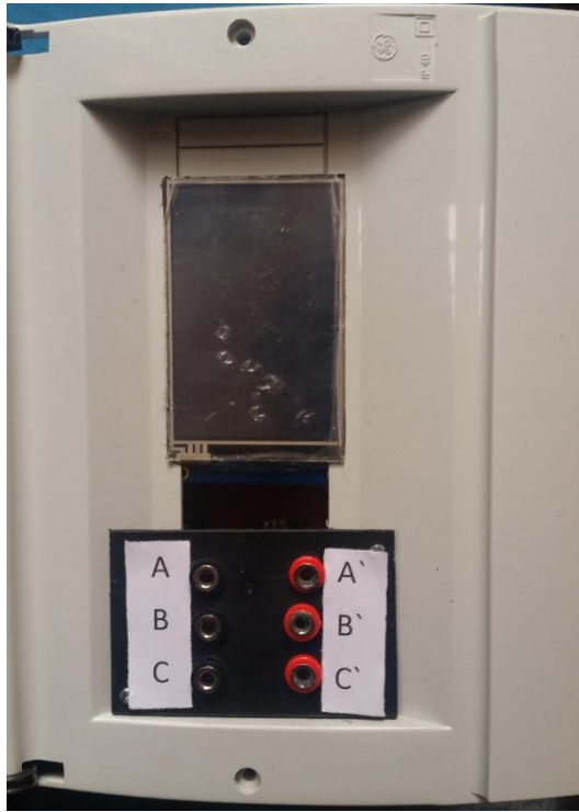
Figura 5.26 Conexión de la carga en el módulo de sobrecorrientes
