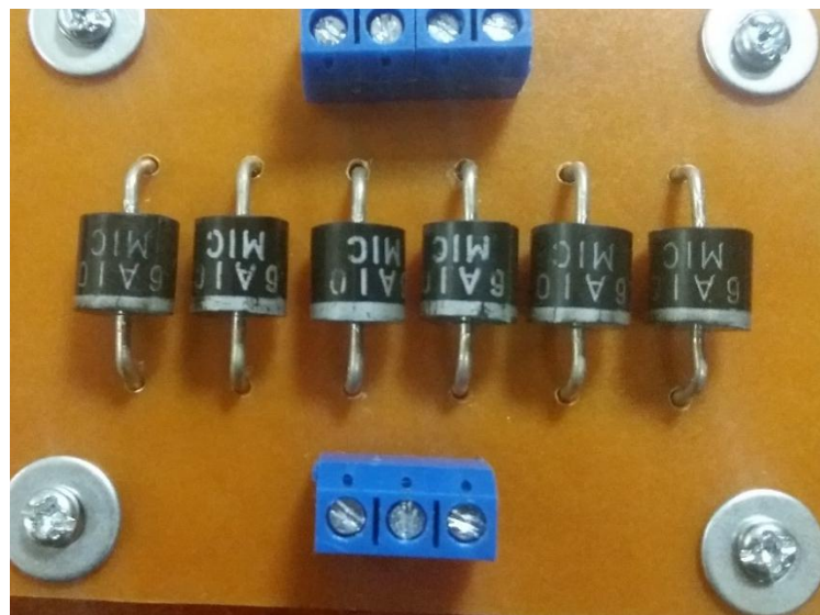
Figura 5.8: Banco de diodos del rectificador Trifásico.
