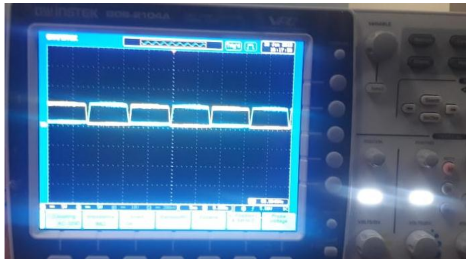
Figura 5.12: Formas de onda rectificador trifásico controlado vistas en el osciloscopio.
