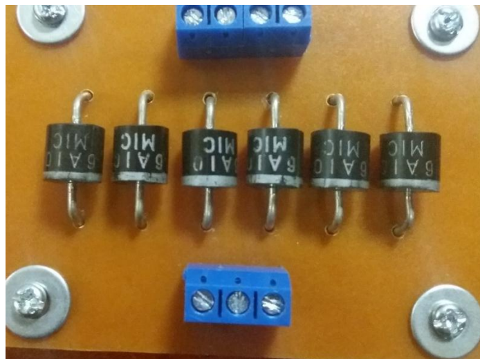
Figura 5.1. Banco de diodos para rectificador monofásico.
