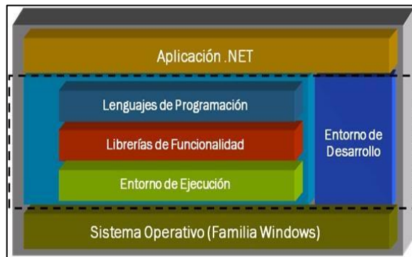
Figura 8: Plataforma de ejecución intermedia Fuente: Chamoun [14]
