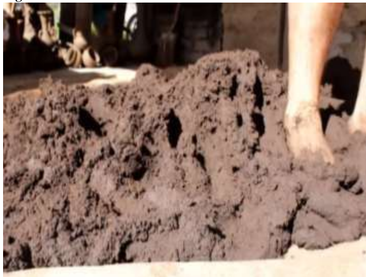
Figura N° 13: Condiciones de amasado de arcilla manual
