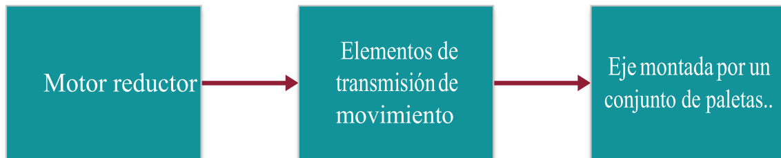
Figura N° 14: Mecanismos de una máquina para amasar la arcilla
