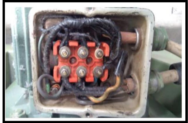
FIGURA 5. 17. Conexiones de borneras en mal estado
