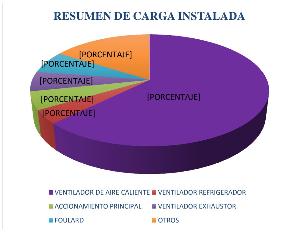
FIGURA 5. 2. Resumen de carga instalada porcentual de motores
