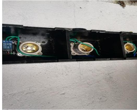
**Fotografía C.8:** Conexión de las lámparas LED
