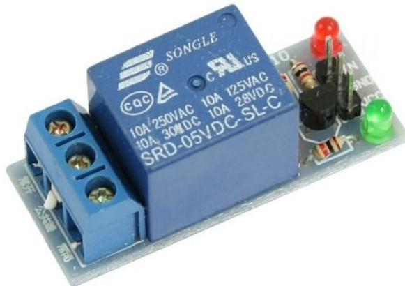
**Figura 3.17:** Módulo relé para Arduino
