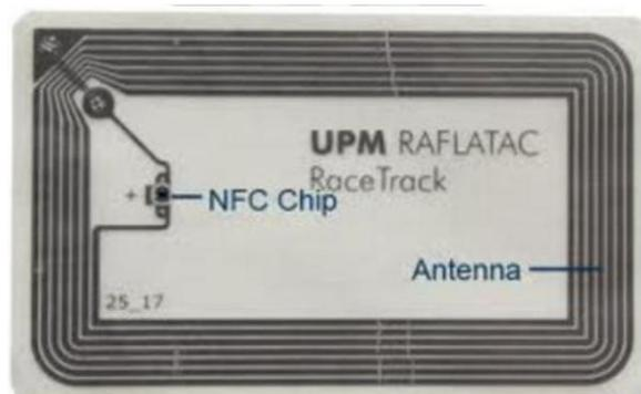
**Figura 3.2:** Tarjeta RFID pasiva
