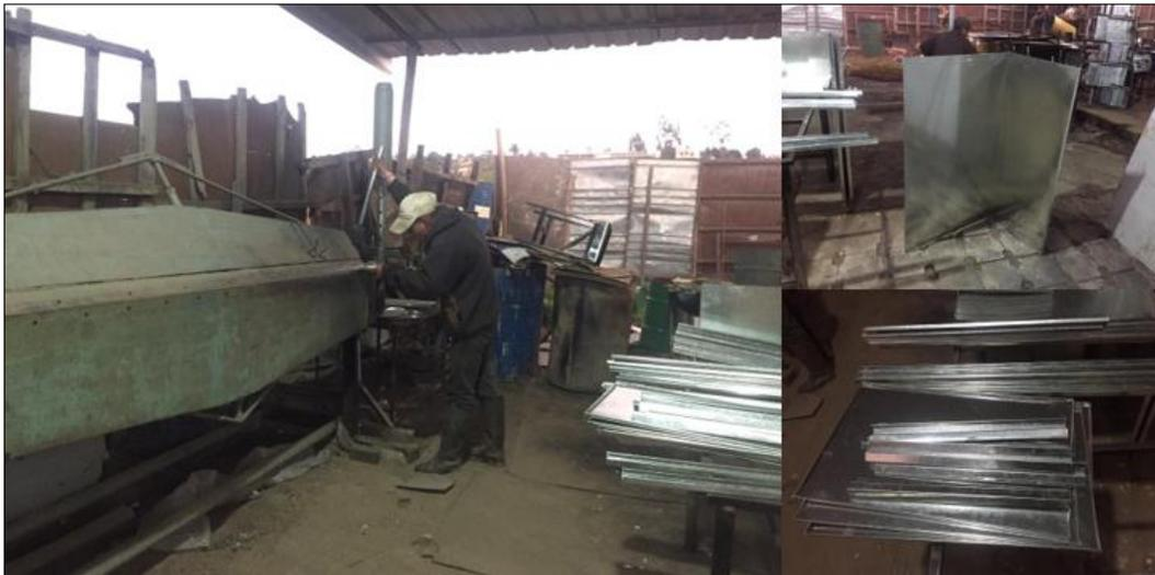
En este proceso se enmarcan los puntos de doblado, utilizando la dobladora que se puede visualizar en esta imagen correspondiente a la etapa 7.
