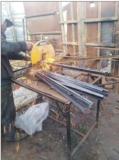
El Corte del material que no necesita ser trazado es realizado por medio de la maquina denominada trazadora.
