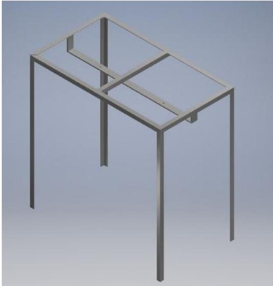
La unión de la estructura es realizada a través de la suelda, a causa del peligro visual que implica este proceso se ha plasmado el diseño del programa “INVENTOR” elaborado por los autores.
