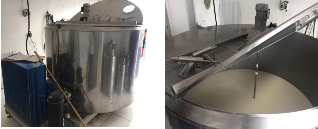
Figura 22. Tanque de enfriamiento
