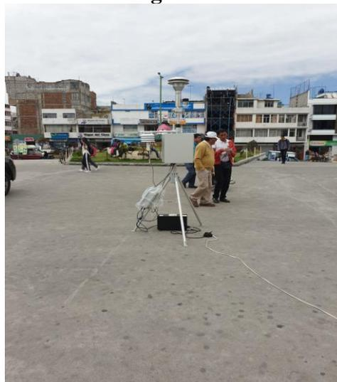
**Fotografía 13. Instalación de equipo E - BAM y toma de datos en la Plazoleta San Agustín**
