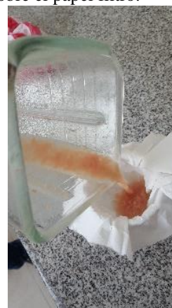
Fotografía 20: Colocación de la muestra licuada sobre el papel filtro.
