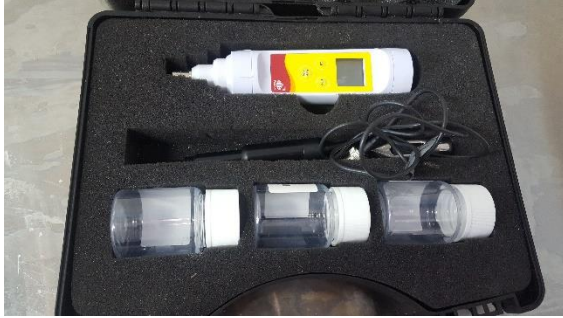
Fotografía 27: Potenciómetro portátil pinchador marca alla France especial para carnes.
