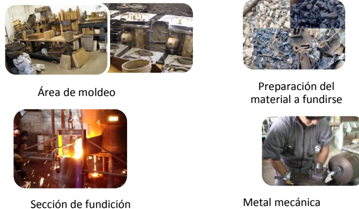
Figura N° 1. 6. Esquema de las áreas de proceso de fundición
