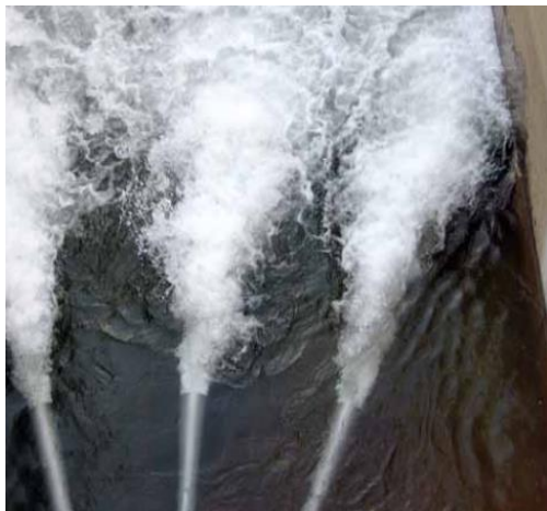
El aireador de chorro Flygt consta de tuberías de aspiración de aire, una bomba N y eyectores y su alojamiento.
