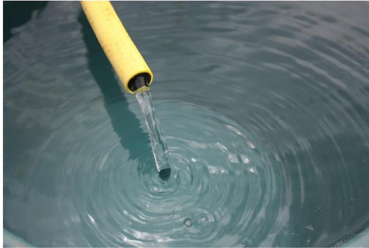
En la foto 3.4 se tiene el tanque de reserva que alcanzó una altura de 3 m y en 5 horas de trabajo continuo de la bomba que utilizo como fuente de energía primaria el sistema solar fotovoltaico, se llenó con 120 litros de agua.
