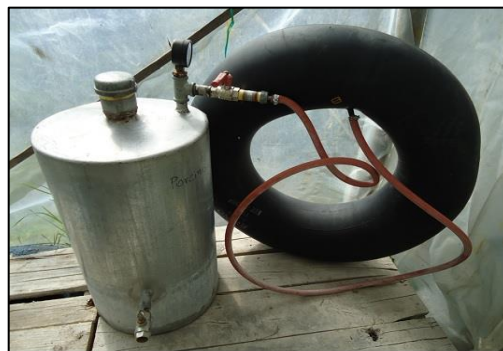
Figura 2.8. Gasómetro utilizado para el experimento.
