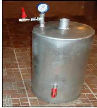
Figura 2.9. Biodigestor sin aislamiento térmico.
