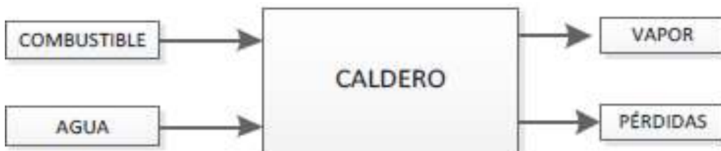
Figura 1.1. Balance energético para una caldera de vapor
