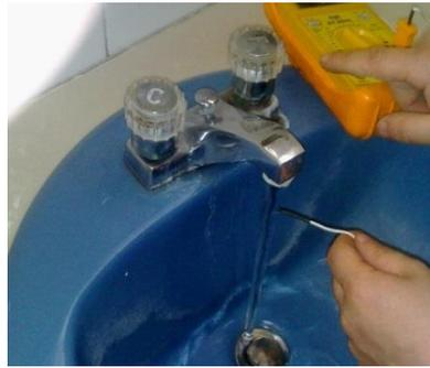
Figura 3.09 Medición de Temperatura con termocupla Tipo K
