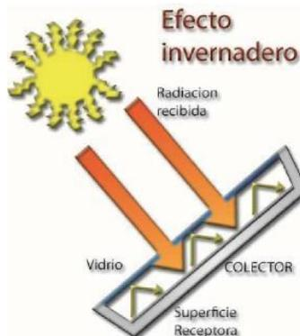
Figura 2.2 Efecto Invernadero en un colector
