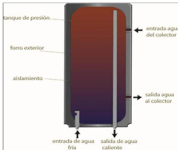
Figura 2.4 Corte de Tanque Termosolar sin intercambiador
