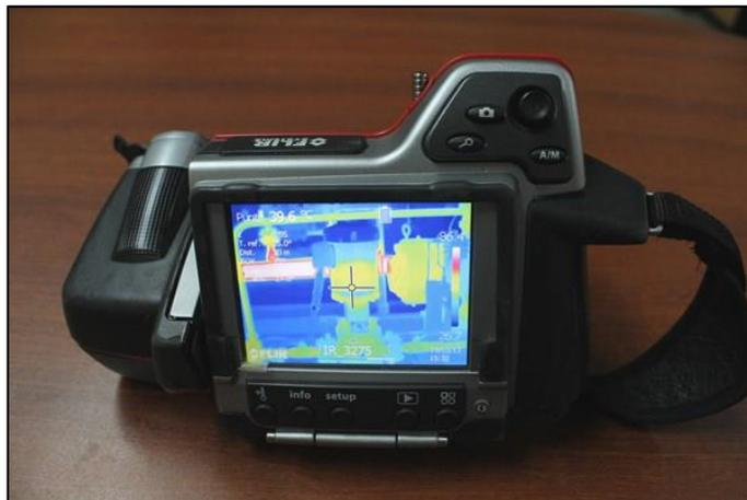
Figura 3.2. Cámara Termográfica Flir T360.
