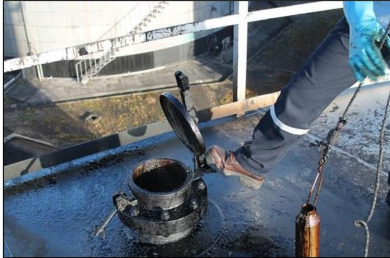
Figura 3.6. Toma de muestra de crudo reducido.
