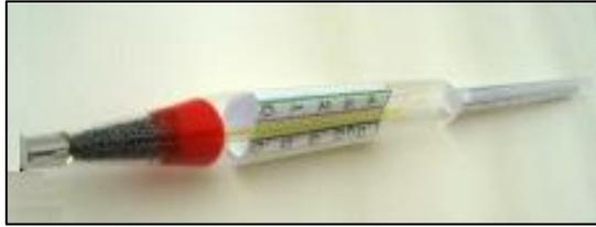
Figura 3.3. Termo-hidrómetro.
