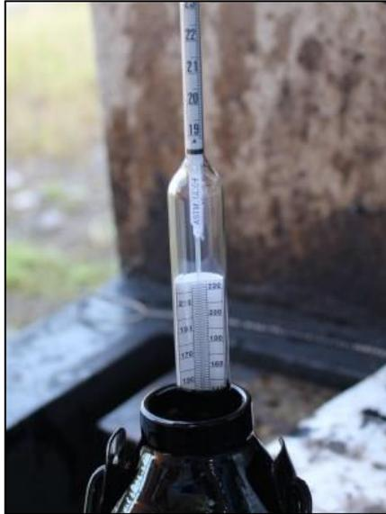
Figura 3.7. Medición del grado API observado.
