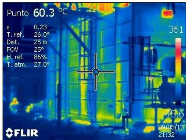
Figura 4.7. Imagen termográfica del horno de crudo C2H001.
