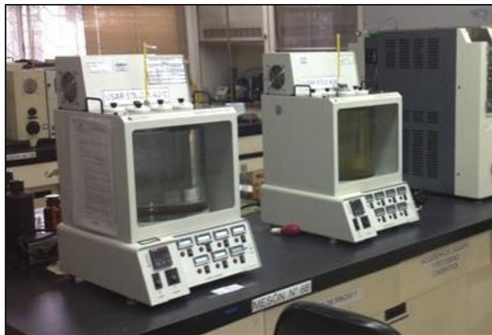
Figura 3.4. Baño para determinación de viscosidad cinemática Koehler KV3000.
