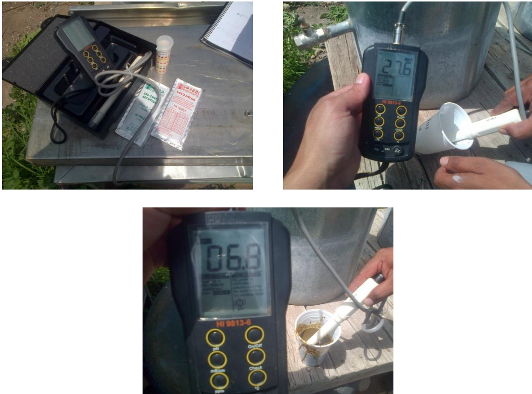
Figura 3. 5 Instrumento HANNA HI9813-6 utilizado para medición de temperaturas y PH.
