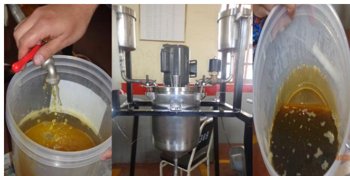
Figura 2. 3 Proceso de transesterificación
