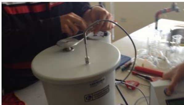
Figura 3.9 Sellado de bomba calorimétrica
