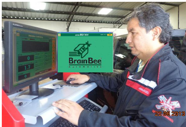
Figura 3. 18 Acceso al analizador de opacidad
