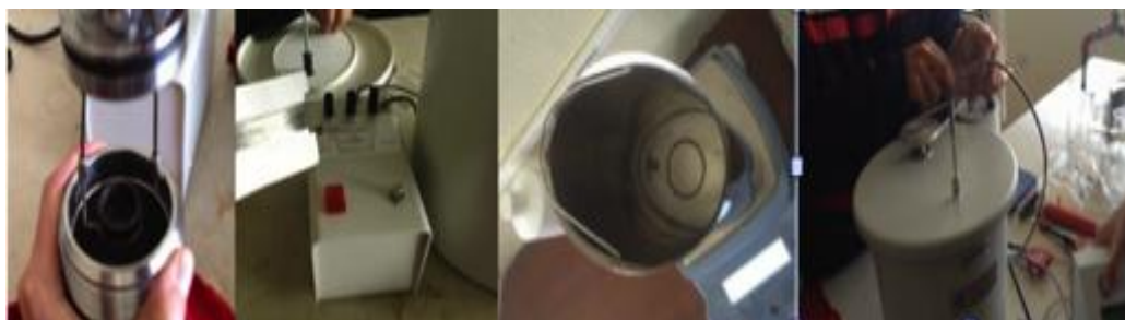
Figura 3.6 Procedimiento de uso bomba calorimétrica.
