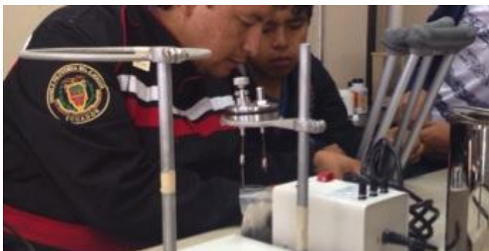
Figura 3. 5 Preparación de la bomba calorimétrica Parr 1341
