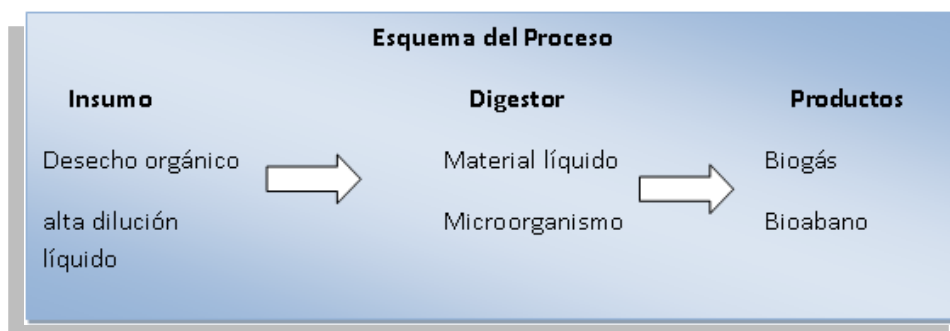
Figura 4: Esquema del proceso de fermentación continua
