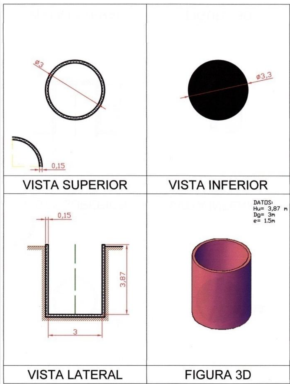
Figura 14: Dimensiones de los dos biodigestores de 42 m 3
