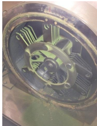
Figura 7 Martillos del molino de frutos y hojas secas de la empresa Aromas del Tungurahua
