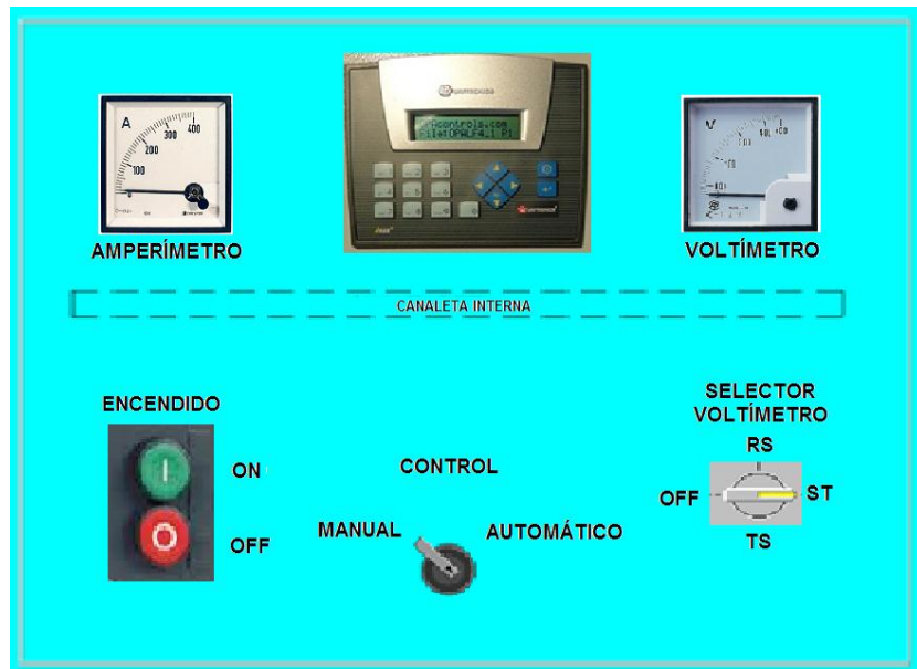
Figura 28 Disposición física de los elementos en la parte frontal del tablero.
