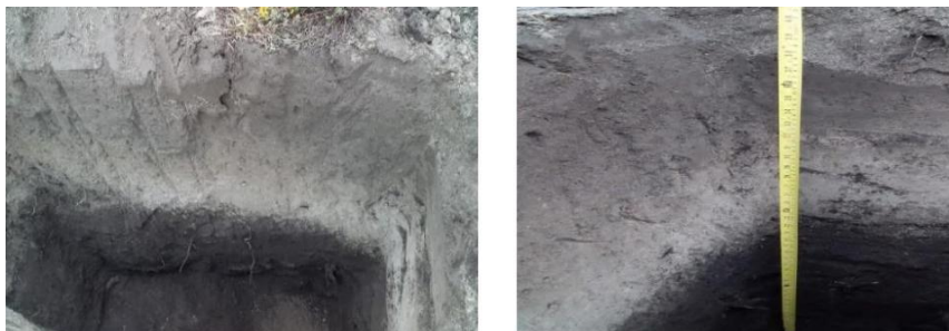
Imagen 4. Calicata del suelo
