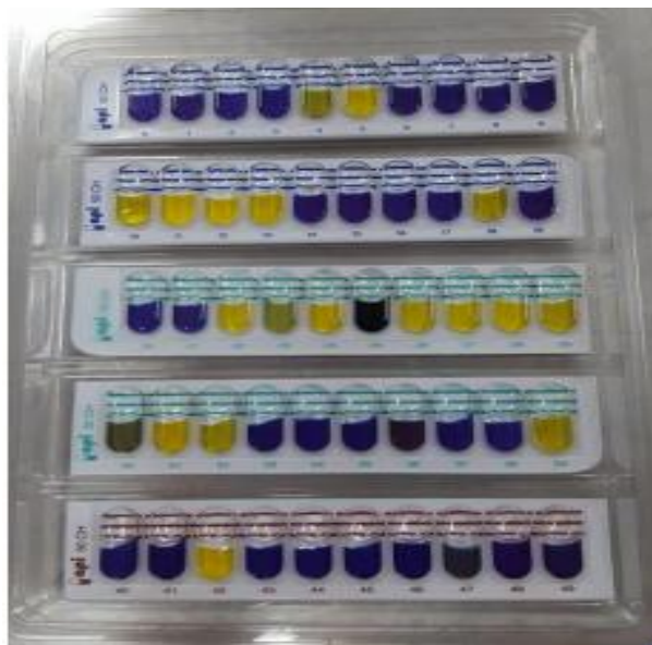
Imagen 8: Galería enzimática (metabolismo de hidratos de carbono) API 50 CH para bacterias ácido lácticas y levaduras
