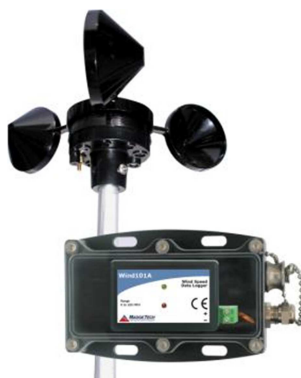
Figura 3.4. Anemómetro y registrador de datos. Fuente: MadgeTech.
