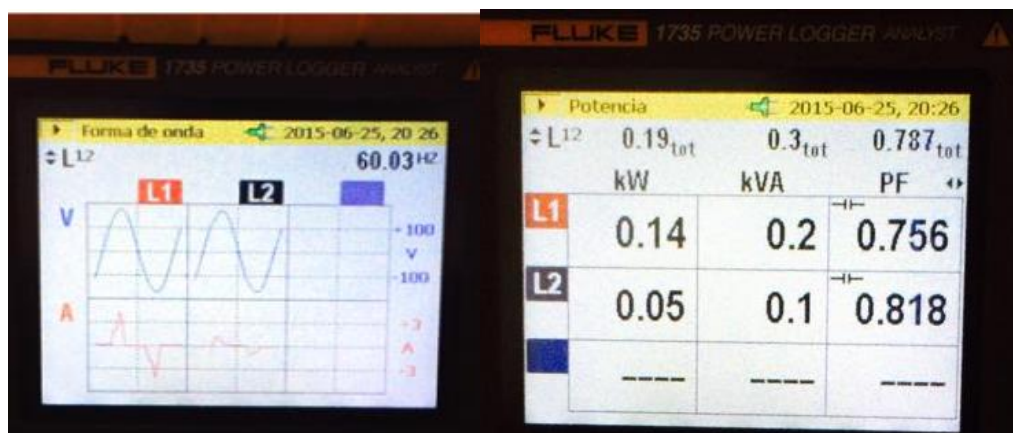
Figura 26: a) Forma de onda del voltaje y corriente b) Parámetros de potencia de la L1 y L2 de medición del analizador FLUKE 1735 Elaborado por: Salazar Achig Edgar Roberto (2015)
