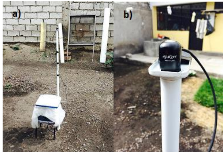
Figura 31: Instalación del piranómetro MP-200 en el patio trasero de la vivienda a) Vista frontal a la casa b) vista trasera de la casa Elaborado por: Salazar Achig Edgar Roberto (2015)
