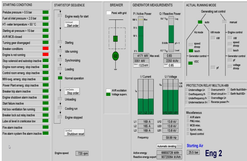
Figura 16 Pantalla de control Scada Generación.
