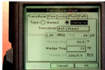
Figura 2. 17. TransPort® PT878GC transductor (Fuente: Aimacaña, 2016)
