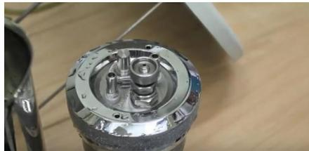
**Figura 2. 31. Calorímetro Parr 1341. Desarmar la bomba (Fuente: Aimacaña, 2016)**
