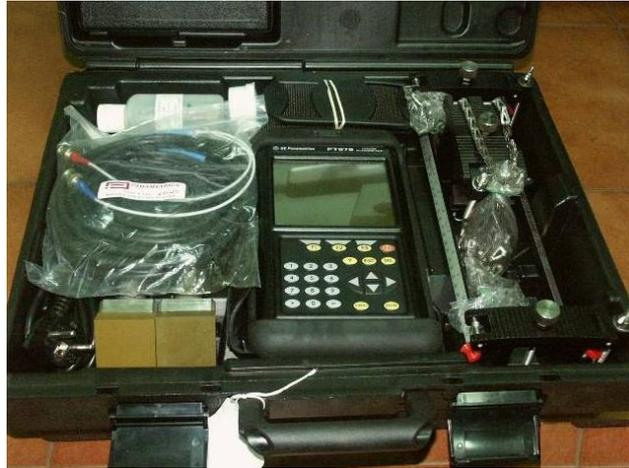
**Figura 2. 9. Flujómetro TransPort® PT878GC (Fuente: General, 2004)**
