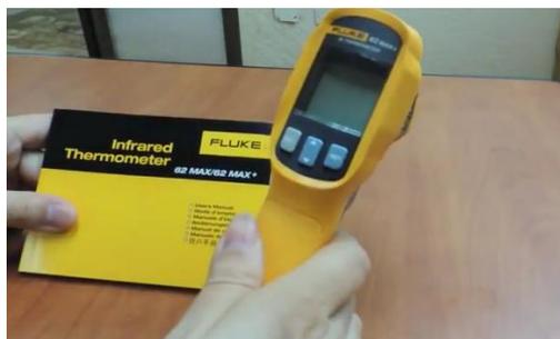
Figura 2. 6. Termómetro infrarrojo Fluke 62 Max (Fuente: Aimacaña, 2016).
