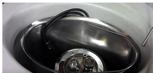
**Figura 2. 27. Calorímetro Parr 1341 llenar el calorímetro (Fuente: Aimacaña, 2016)**
