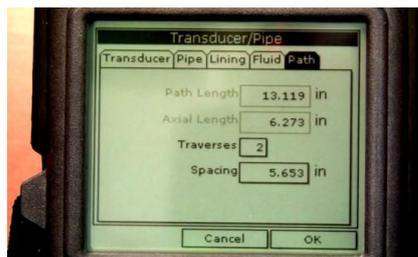
**Figura 2. 21. TransPort® PT878GC, Path (Fuente: Aimacaña, 2016)**
