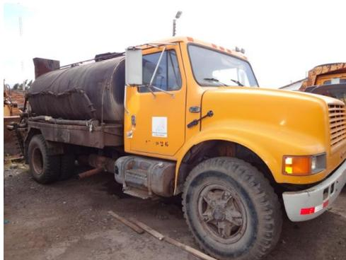
Figura 1. 4. Distribuidor de asfalto marca Rosco (Fuente: Aimacaña, 2016)
