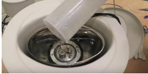
**Figura 2. 28. Calorímetro Parr 1341 ajustar el balde (Fuente: Aimacaña, 2016)**
