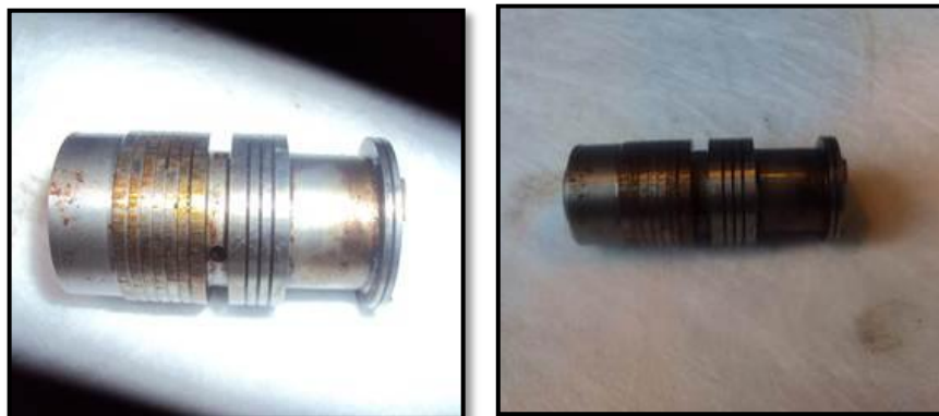
Figura 3.38 Vástago válvula de combustible
