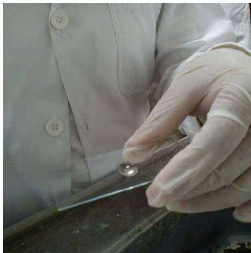
Foto 9: Colocación de la muestra en el portaobjetos
