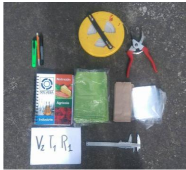
FOTOGRAFÍA 1. materiales usados para el experimento: fundas de tela, papel, y polietileno, pie de rey, flexómetro, tijeras de podar, libreta de campo, rótulos, un marcador, un lápiz, estilete.
