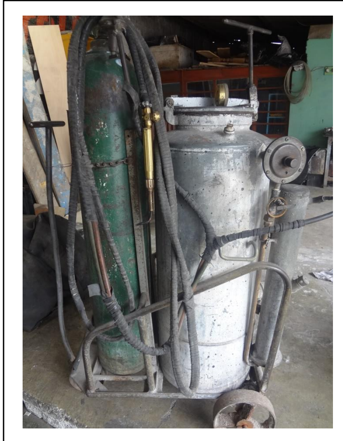
Figura 3. 10 Generador de acetileno Elaborado por: Maldonado Carlos
