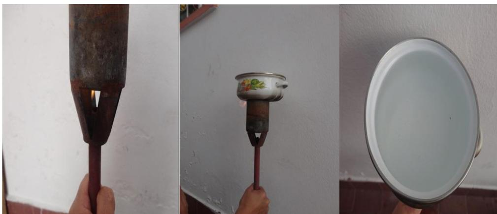
**Figura No. 16 Combustión del biogás y GLP.**
