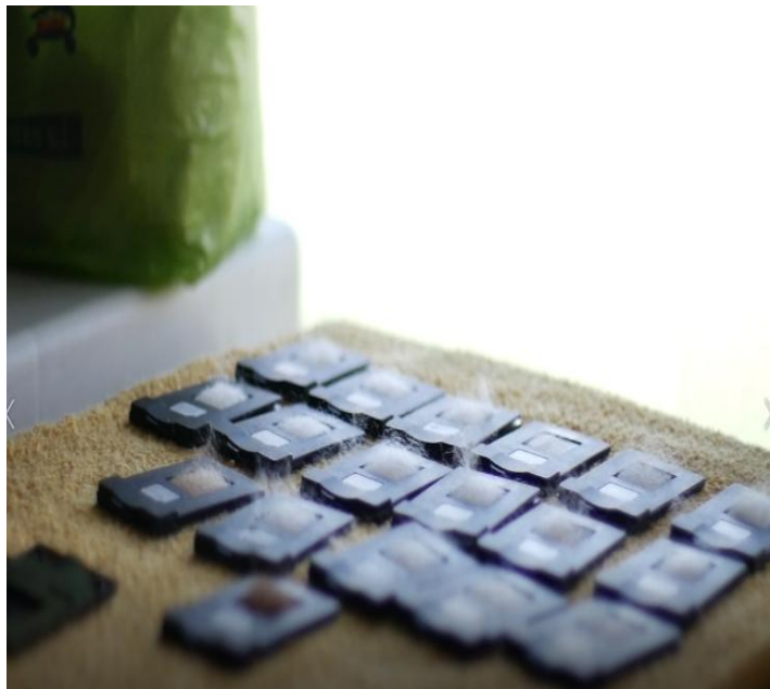
Fotografía 23. Colocación de la muestra en los casets para introducirlos en el Equipo fibrelux
