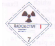
Categoría I-Blanco Símbolo (trébol esquematizado) negro, Fondo blanco Texto (obligatorio) en negro en la mitad inferior de la etiqueta "RADIOACTIVO" "CONTENIDO..." "ACTIVIDAD..." La palabra "Radioactivo" ira seguida de una raya vertical roja; Número "7" en el ángulo inferior
