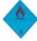
División 4.3 Sustancias que en contacto con el agua desprenden gases inflamables Símbolo (llama), negro o blanco Fondo, azul; Número "4" en el ángulo inferior
