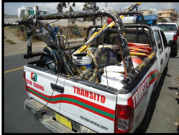
Foto N°1: VEHICULO PARA TRANSPORTE DE EQUIPOS Y PINTURA DE ALTO TRÁFICO
