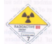
Categoría III-Amarilla Símbolo (trébol esquematizado) negro, Fondo mitad superior amarilla con borde blanco, mitad inferior blanca Texto (obligatorio) en negro en la mitad inferior de la etiqueta "RADIOACTIVO" "CONTENIDO..." "ACTIVIDAD..." En un recuadro de líneas negras "Índice de transporte" La palabra "radioactivo" debe ir seguida de tres rayas verticales rojas Número "7" en el ángulo inferior
