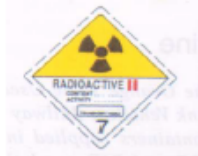
Categoría II-Amarilla Símbolo (trébol esquematizado) negro, Fondo mitad superior amarilla con borde blanco, mitad inferior blanca Texto (obligatorio) en negro en la mitad inferior de la etiqueta "RADIOACTIVO" "CONTENIDO..." "ACTIVIDAD..." En un recuadro de líneas negras "Índice de transporte" La palabra "radioactivo" debe ir seguida de dos rayas verticales rojas Número "7" en el ángulo inferior
