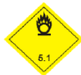
División 5.1 Substancias comburentes Símbolo (llama sobre un círculo) negro; Fondo amarillo Número "5.1" en el ángulo inferior
