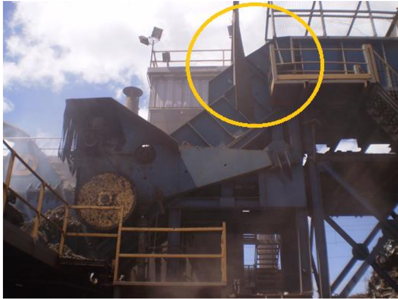
Gráfico N° 21: Zona de las cortina de seguridad - Fragmentadora Fuente: Propia
