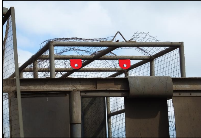
Gráfico N° 8: Ubicación de puntos de anclaje en la zona de mallado - Fragmentadora Fuente: Propia
