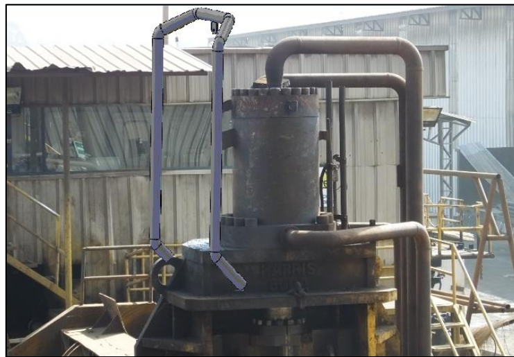
Gráfico N° 12: Puntos de anclaje en la zona alta de cilindros hidráulicos – Prensa Cizalla Fuente: Propia
