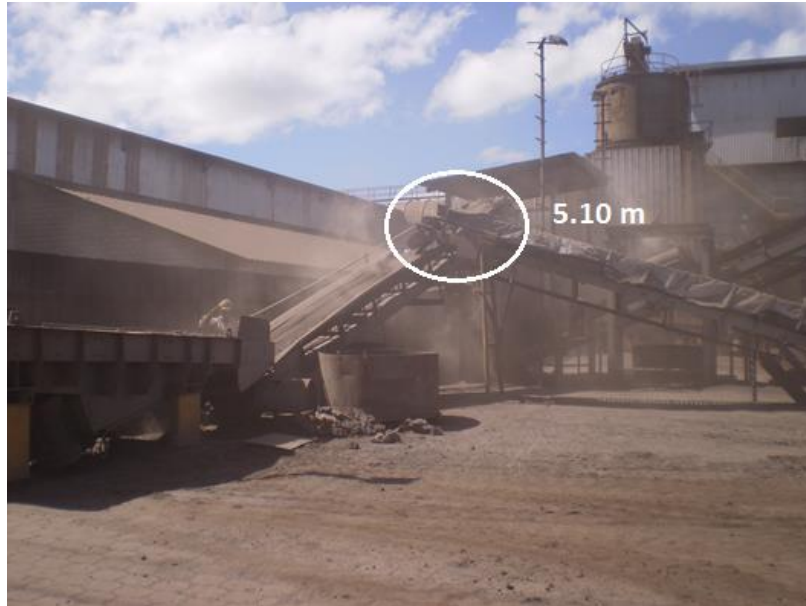
Gráfico N° 9: Zona alta de rodillos – Trituradora de escoria Fuente: Propia
