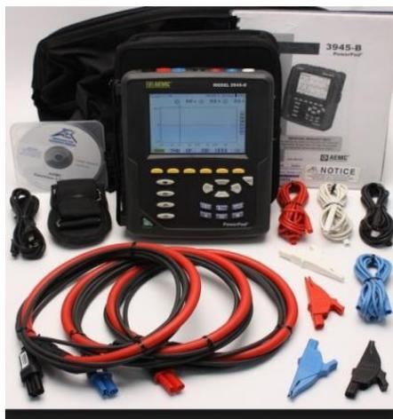
**Gráfico No. 15: Analizador de energía PowerPad Modelo 3945-**
