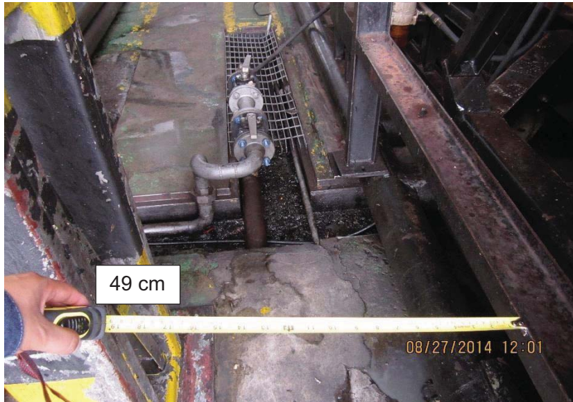
Ilustración 8 ANCHO DE PASILLO INADECUADO Y CHARCO EN EL PISO
