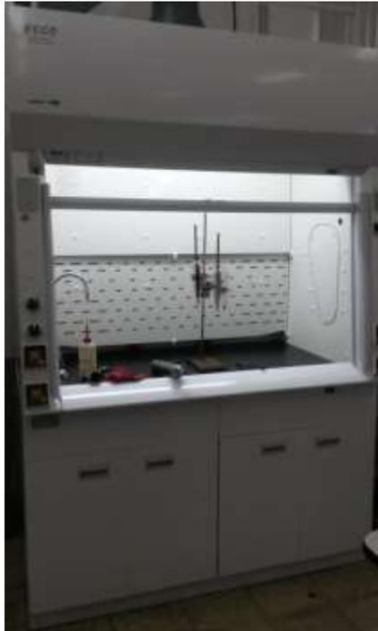
Figura 17. Campana de extracción de gas ESCO, Frontier Acela.
