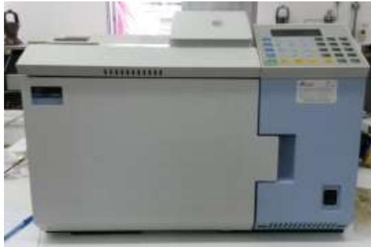
Figura 19. Cromatógrafo Perkin Elmer Arnel.
