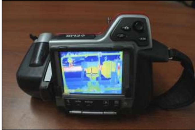
Figura 15. Cámara Termográfica Flir T360.
